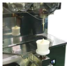
電動昇降テーブル 充填後にカップを振動させる 事で、充填物の形を整えます。
